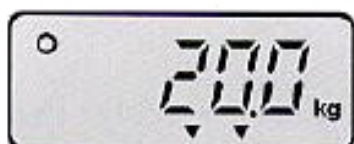
Aby wyświetlić masę NETO ( samego towaru ) Nacisnąć klawisz NET/GROSS Zdjąć pojemnik i towar aby wyświetlić masę TARA
