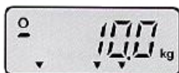
Aby wyświetlić masę TARA ( pojemnika ) Zdjąć pojemnik i towar z platformy i nacisnąć TARE
